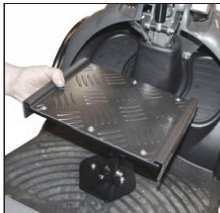
Boltes fast med de medfølgende skruer.
