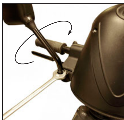
Skru sidespejlet på, ved at dreje hele spejlet rundt med uret. Sættes i rigtig vinkel og spænd kontra med en 17 nøgle.
