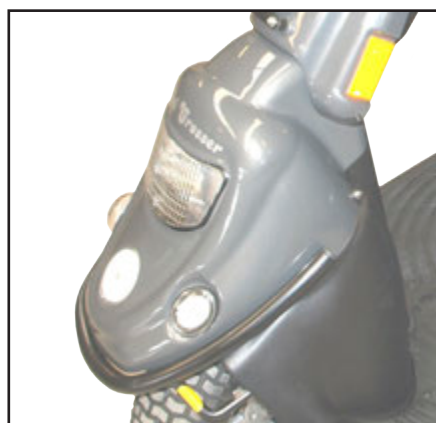
På 3W skal forskærmen afmonteres inden man kan skifte pære.
