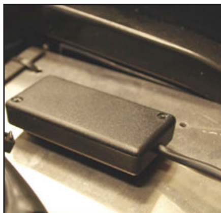
Monteres med velcro på el-pladen.
