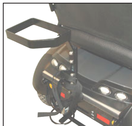
På samme vis monteres holder for iltapparat.
